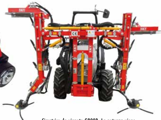
Cimatrice da vigneto G800B. La potenza viene erogata dalle prese oleoidrauliche della trattoria stessa oppure da una centralina indipendente.
