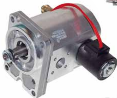
Motori Marzocchi con valvole integrate direttamente nel coperchio: ALM1-S-9-VM-E1/60 con valvola di massima. ALM2BK1-D-12 con valvola elettroproporzionale e presa di pressione.
