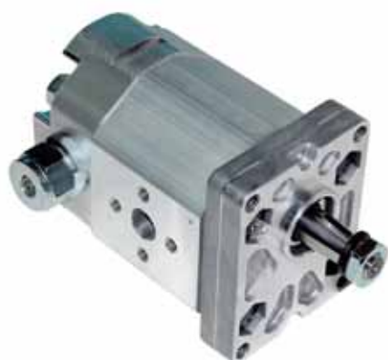
Motori Marzocchi con valvole integrate direttamente nel coperchio: ALM1-S-9-VM-E1/60 con valvola di massima. ALM2BK1-D-12 con valvola elettroproporzionale e presa di pressione.
